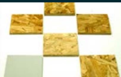
Como resultado se obtienen tableros libres de nudos y grietas, estables y uniformes, que son fáciles de cortar, clavar o atornillar, utilizando herramientas de uso común
